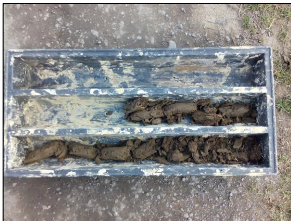
Foto č. 2: Profil vrtu V3 – jílovité zeminy
