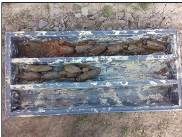
Foto č. 1: Profil vrtu V1 – navážky a jíly
