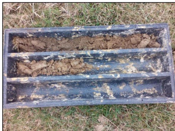
Foto č. 4: Profil vrtu V10 – jílovité zeminy
