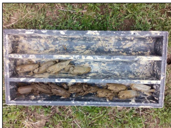
Foto č. 3: Profil vrtu V7 – jílovité zeminy
